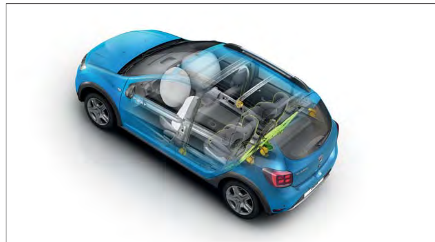
Protection : Structure renforcée, airbags frontaux et latéraux avant, système de fixation Isofix situé au niveau des places latérales arrière.
