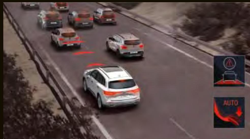
**Freinage actif d'urgence.** En cas de freinage d'urgence, le système agit en complément de l'ABS/ESC pour réduire les distances d'arrêt.
