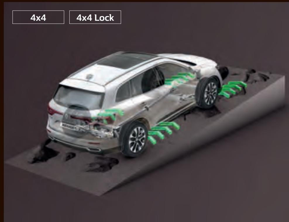
Sélectionnez Auto pour passer automatiquement en mode 4x4 lorsque la situation l'exige, et bénéficiez d'une répartition automatique du couple entre les roues avant et arrière. Choisissez le mode Lock pour une transmission permanente des quatre roues et une répartition fixe du couple entre l'avant et l'arrière, afin de maximiser la capacité de franchissement et la stabilité dans tout environnement. Passez à l'action et dépassez-vous avec le All Mode 4x4-i de Nouveau Koleos !
